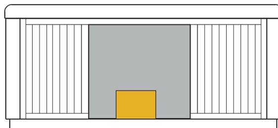
Rimuovere anche il pannello laterale e provvedere alla foratura del fondale per il passaggio del cavo (all'interno dell'area indicata a lato). Eseguire collegamento elettrico alla centralina.
